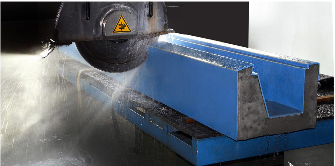
*Passgenaue Beton-Fertigteile mit integrierter Auskleidungstechnologie werden individuell vorgefertigt und vor Ort montiert. BEKAPOOL spart bis zu 25% an Kosten gegenüber herkömmlichen Schwimmbad-Baukonzepten.*
